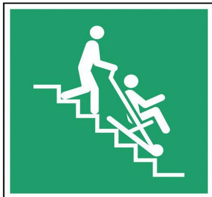
Figura 1 – Il cartello che serve a identificare la collocazione di una sedia da evacuazione
