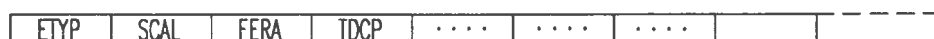
Figura 6.1: Struttura di un record in cui viene scritto un'evento acquisito dallo spettrometro. Ogni record è suddiviso in banche, in cui sono raggruppati i dati provenienti da parti uguali dello spettrometro.
