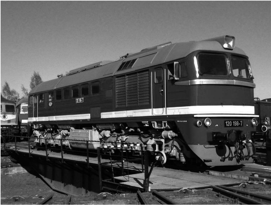
Foto 3) Loco diesel-elettrica Br 120 . (Ex V 200, dal 1992 Br. 220). Fu la variante del gruppo sovietico M62, che venne venduta alle ferrovie di quasi tutti i Paesi satelliti. L'unità nella foto risale al 1967. Con rodiggio Co'Co', sviluppava una potenza massima di 1.470 kW con una velocità massima di 100 km/h. L'esemplare nella foto è in perfetto ordine di marcia e si occupa anch'esso del traino di treni storici e d'agenzia.
