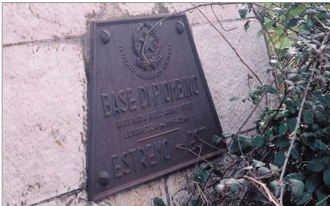
Fig. 2 – Particolare del caposaldo fuori centro della base geodetica di Piombino (1959), estremo est (foto Autore)
