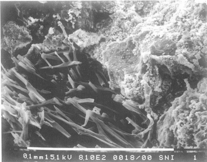
Fig. 8 - Microfotografia al Sem di Verrucaria nigrescens su intonaco. Profondità 1 mm.
