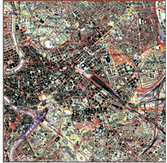
Fig. 1b (tratta da documentazione I.G.M.)- Le quattro Sezioni 1:25000 riunite, sottoposte alla riorganizzazione dei dati, variazione dei simboli, incremento corpo caratteri toponomastica e ridotte alla scala 1:50000 (come si può notare facilmente, la situazione del disegno è caotica e quindi illeggibile)
