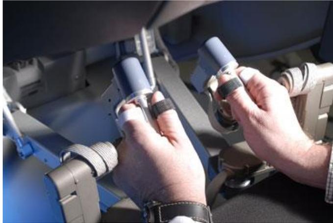
Figura 8. Il chirurgo manipola, con il joystick, l'estremità di uno strumento chirurgico all'esterno del corpo mentre visualizza l'azione all'interno del corpo su un monitor televisivo (Fonte: <<https://www.kasselmvcvey.com/robot-case/>>).
