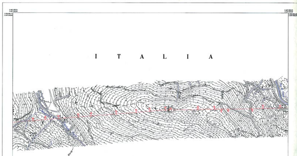
Fig. 1 - Particolare del foglio n° 82 delle carte di Osimo: si notino i vertici NE e NO e le relative doppie coordinate. In rosso la linea di confine, in blu l'idrografia.
