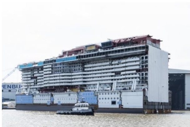
Figura 5. Installazione delle cabine passeggeri prefabbricate nella costruzione di una nave da crociera (Fonte: Fincantieri).
