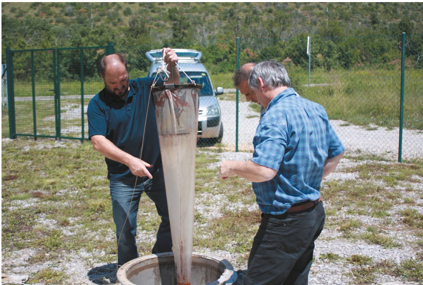
Figura 6.5 Prelievo di campioni di fauna nel pozzo di emungimento dell'acquedotto di Klariči
