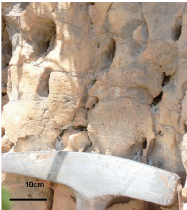
Fig. 6 Stylolite. I picchi stiloliti sono quasi del tutto arrotondati, ma la forma originaria della discontinuità è ancora riconoscibile
