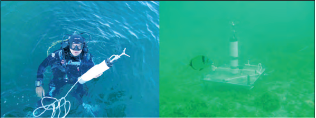
Fig. 16 - Posizionamento dell'ondametro sul fondale
