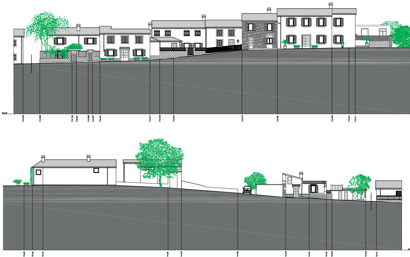
Sopra: immagine di prospetto regolare con edifici in buono stato di conservazione Sotto: il lato opposto presenta irregolarità e mancanza di coerenza degli edifici probabilmente frutto di ampliamenti recenti e non regolati adeguatamente dalla normativa.
