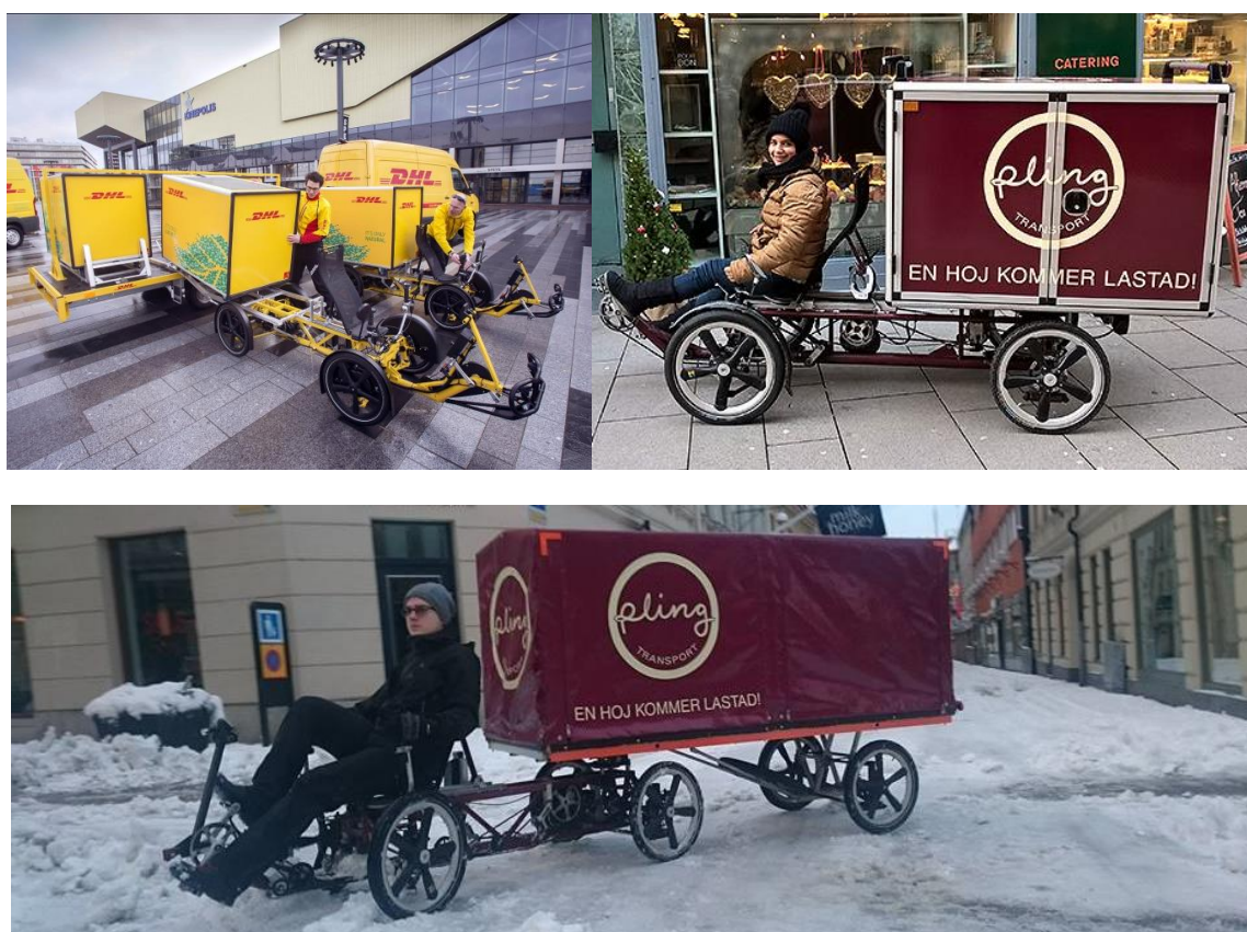
Figura 5. Esempi di quadricicli merci. Nell'immagine in basso anche con rimorchio. (fonte: dhl.com, plingtransport.se)
