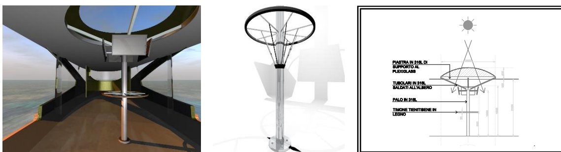
Figura 28. Studio della zona imbarco passeggeri e tubolare di appiglio. (Disegno: gruppo di lavoro del Master - Università di Trieste)
