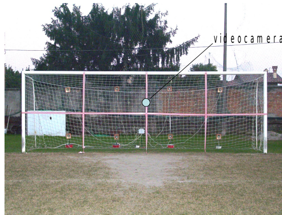
Figura 4.2: divisione della porta e posizione della telecamera
