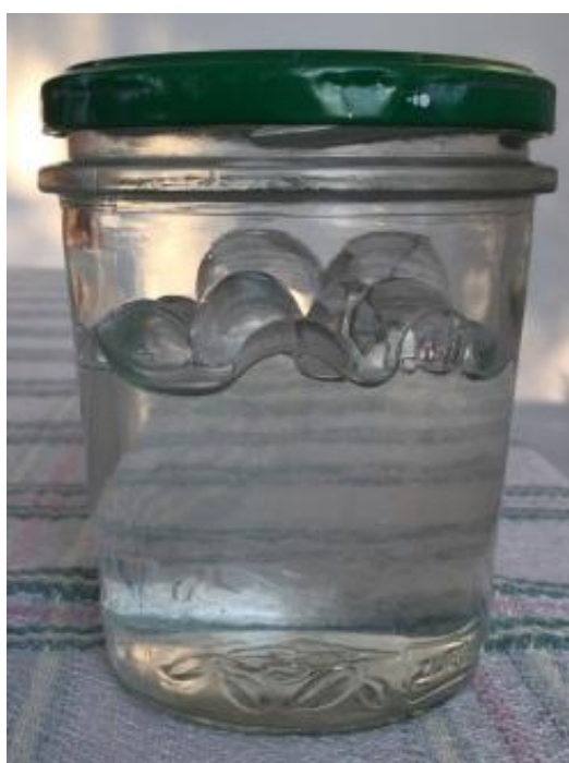
Figura 3. Trasparenza : osservazione dell'effetto ottico di un materiale trasparente immerso nell'acqua, avente indice di rifrazione molto vicino a quello dell'acqua e densità maggiore (Foto: A. Rambelli).
