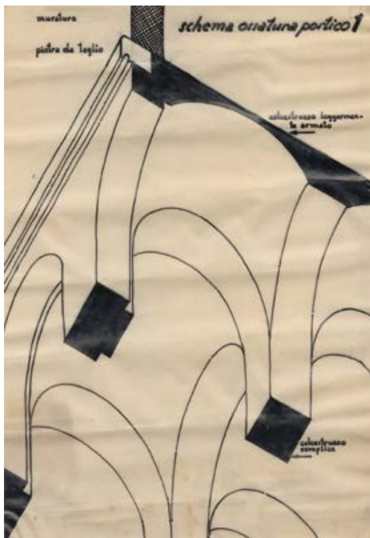
E. Bianchini (attr.), schema strutturale del portico dell'Edificio Centrale (ASFi, R. Fagnoni, Elaborati grafici in cartelle , 38, c. 38)
