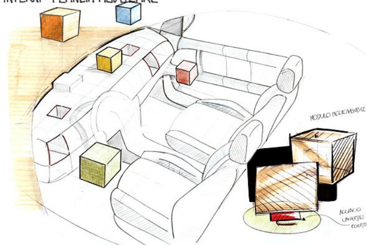
Figura 16. In alto: bozzetto con la rappresentazione del volante e dei comandi. Al centro: Evidenziazione dell'illuminazione degli strumenti di controllo. Sotto: Inserimento modulare degli altoparlanti per l'amplificazione sonora nell'abitacolo (Disegni: Gabriele Cossu).
